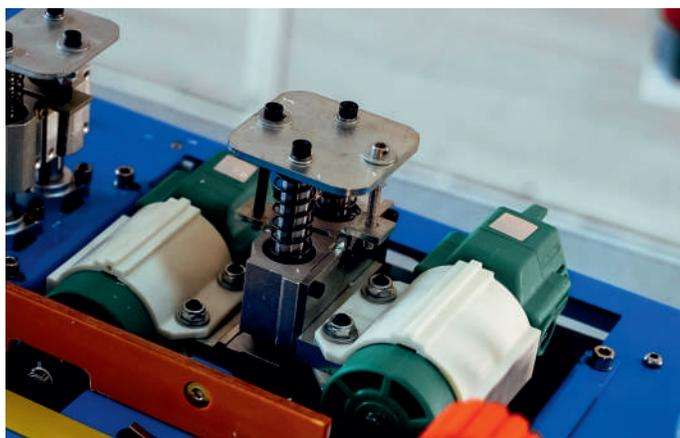
Регулировка верхнего и нижнего фрезера, происходит путем вращения регулировочных винтов (для верхнего фрезера).
