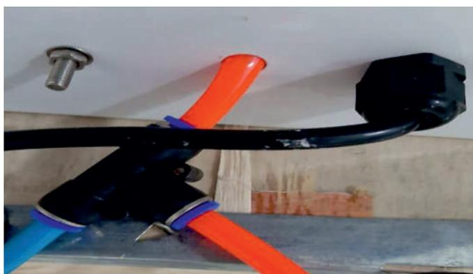
Подключите компрессор к пневмошлангу станка и выносной гильотины через тройник
