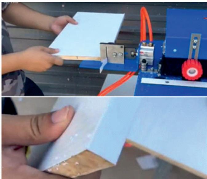
Передвигайте деталь вперед, «захватив» кромочный материал в зоне прижимного ролика производите приклеивание кромки и передвигайте деталь дальше к фрезерным узлам для снятия лишнего свеса кромочного материала по плоскости.
