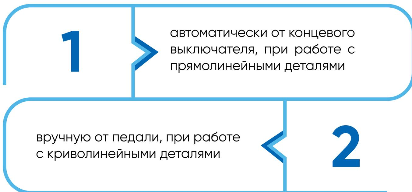
При работе с прямолинейными деталями станок осуществляет фрезеровку сверху и снизу заготовки в полуавтоматическом режиме.
