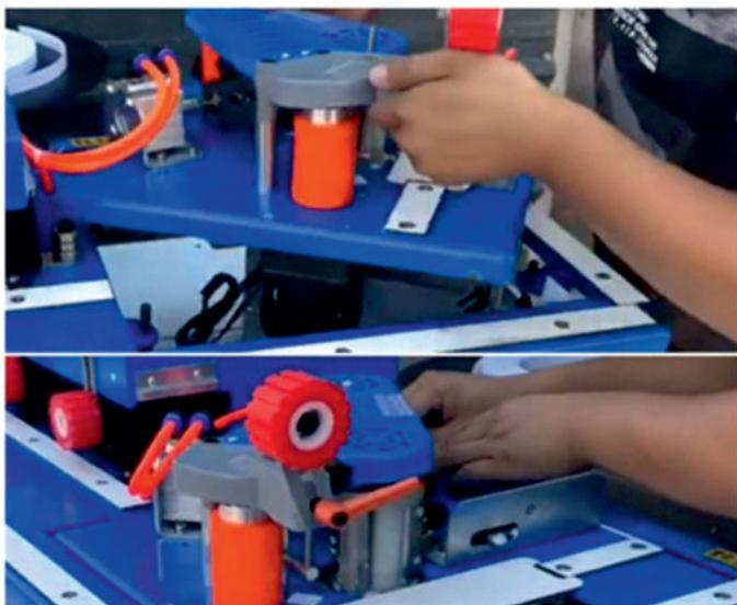
Для приклеивания кромки на криволинейные детали, необходимо произвести поворот клевого узла как на картинке. (форма опоры поворачиваемой клеевой ванны может быть квадратной или круглой, в зависимости от модели).
