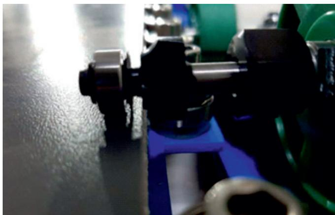
Чтобы обеспечить правильное фрезерование свесов кромки, нужно настроить фрезерные узлы так, чтобы подшипники верхнего и нижнего фрезера лежали на самой заготовке с небольшим давлением на нее.
